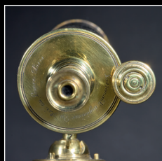
79 Claude Simeon PASSEMANT (1702-1769) Télescope à réflexion en bronze et laiton, corps gainé de cuir noir. Pied tripode dévissable laissant apparaître une queue de cochon pour fixer l'instrument sur un arbre. Signé : « PASSEMANT ingénieur du roi au Louvre, Paris » sur le pourtour de l'oculaire. France, milieu XVIIIe siècle 2 000 / 3 000 €
